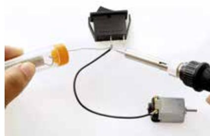
**6.** Das andere Kabelende an einen der Anschlüsse des Schalters löten (welcher Anschluss ist egal).
