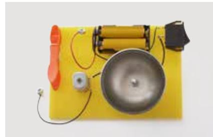
**12.** Batterie, Schalter und Motor auf die Platte kleben. Der Motor kommt über das in Schritt 4 gebohrte Loch. Achtung: Bei diesem Vorgang aufpassen, dass kein Heißkleber auf die Motorwelle kommt.
