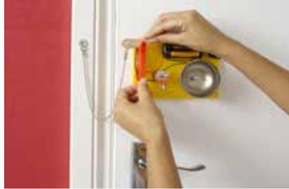
**20.** Nun nur noch den Schalter drücken – schon ist die Alarmanlage scharf. Wenn das nächste Mal jemand die Tür öffnet, wird das Holz aus der Wäscheklammer gezogen und der Alarm ertönt.
