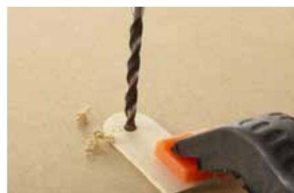
**18.** Nun das Bastelholz durchschneiden und dicht am Ende einer Hälfte ein Loch bohren. Die Kette hindurch fädeln. Das andere Ende der Kette am Türrahmen festschrauben.
