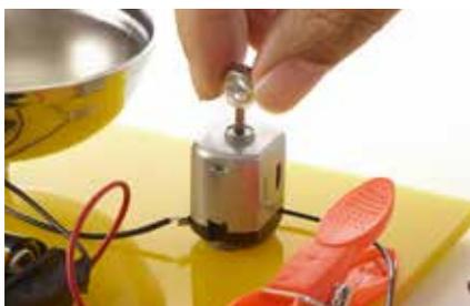
**14.** Eine weitere Mutter wie im Bild oben auf die Motorwelle kleben. Achtung: In den Motor darf kein Kleber tropfen und das Loch der Mutter muss frei bleiben.
