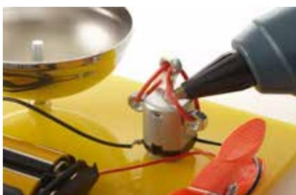
**17.** Die Drahtschleifen mit Heißkleber zukleben. Wenn der Motor sich nun dreht, schlägt immer eine der zwei Muttern gegen die Klingel.
