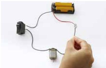
**10.** Batterien einlegen und Schnappverbinder aufstecken. Nun erfolgt der erste Stromkreis-Test: Dafür den Schalter drücken, der Motor sollte sich drehen sobald beide Muttern sich berühren. Nach dem Test wieder ausschalten
