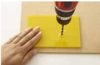
**1.** In die Grundplatte eine Loch bohren. Es sollte rund 5 cm von beiden Kanten entfernt sein. Die Größe des Lochs an die verwendete Schraube für den Klingeldeckel anpassen.
