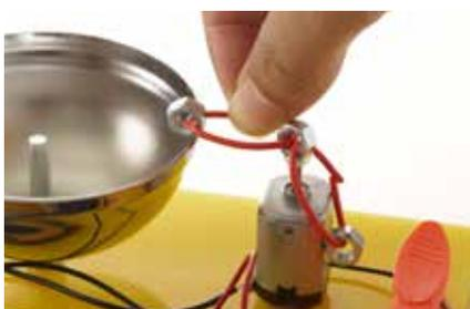
**16.** Die Kabelstücke mit den Muttern durch die Mutter auf der Motorwelle fädeln und zu Schleifen biegen. Beide Muttern müssen den Klingeldeckel erreichen.
