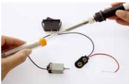
**7.** Etwa 3 cm des roten Anschlusskabels am Batterie-Schnappverbinder isolieren. Dann das schwarze Kabel isolieren und durch Löten mit dem freien Anschluss am Schalter verbinden.
