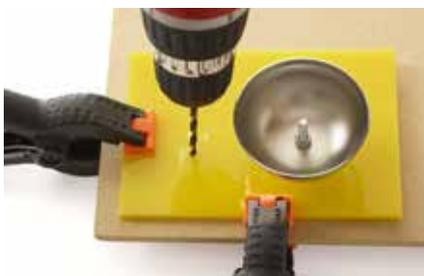
**4.** Drei Zentimeter vom Rand der Glocke entfernt auf der Höhe der Schraube ein 3 mm breites Loch für den Motor bohren.
