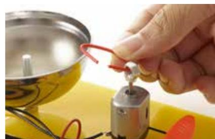
**15.** Zwei Kabelstücke, die je etwa doppelt so lang sind wie die Entfernung von Motorwelle zum Rand der Klingel, zurechtschneiden. Durch je eine Mutter fädeln und in U-Form biegen.
