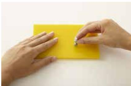
**2.** Die Schraube von unten durch das Loch stecken und drei Muttern bis zum Anschlag darauf drehen.
