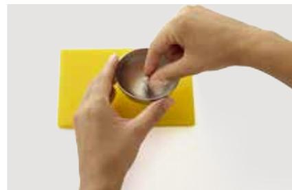
**3.** Klingeldeckel auf die Schraube stecken und mit einer weiteren Mutter befestigen.
