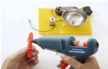
**11.** Eine Seite der Wäschklammer mit Heißkleber bestreichen und auf der Grundplatte befestigen (die greifenden Enden sollte etwa auf Höhe des Batteriepacks sein).
