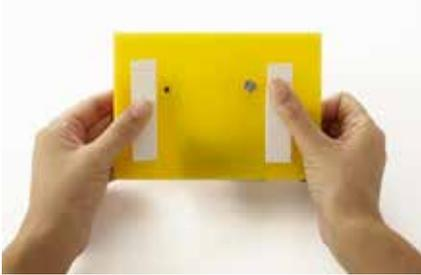
**19.** Die fertige Alarmanlage mit doppelseitigem Klebeband an der Tür befestigen. Die an der Kette befestigte Bastelholzhälfte nun nur noch zwischen die Muttern in der Wäscheklammer stecken – so wird der Stromkreislauf unterbrochen wenn die Türe geschlossen ist.
