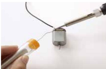
**5.** Vom schwarzen Kabel 10 cm abschneiden und die Enden isolieren. Ein Ende um den Motoranschluss wickeln und festlöten.
