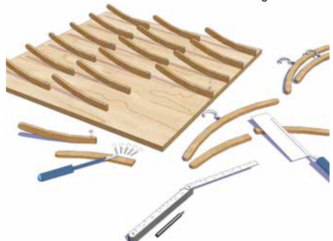
Zuschnitt der Schuhhaken aus Holzkleiderbügeln
