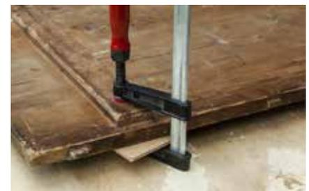
9. Verleimung mit Schraubzwingen fixieren, trocknen lassen. Die Tischverlängerung im Anschluss abschleifen.
