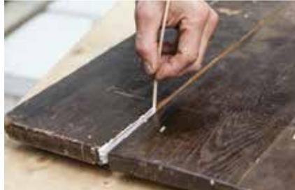
2. Zwischen lose Teile muss Holzleim gebracht werden. Hier gelingt das mit einem Holzspan, auch Einwegspritzen können hilfreich sein.
