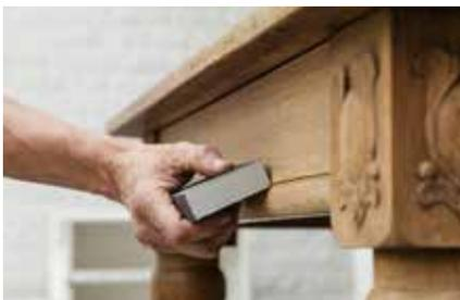
7. Manches muss von Hand geschliffen werden. In die Ecken kommt man gut mit einem Schleifklotz oder mit einem gefalteten Schleifpapier.
