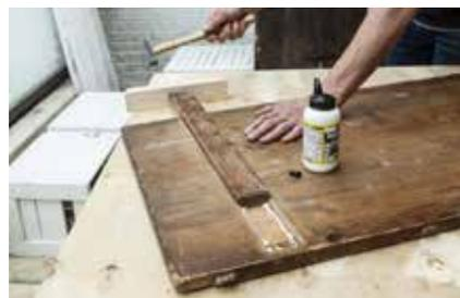
8. Die Gratleiste wird nur am hinteren Ende eingeleimt. So kann die breite Vollholzfläche der Tischverlängerung ungehindert arbeiten, sprich, quellen und schwinden.
