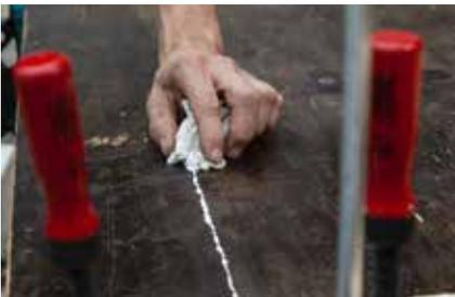
4. Den herausquellenden Leim sofort mit einem feuchten Lappen entfernen, trocknen lassen.
