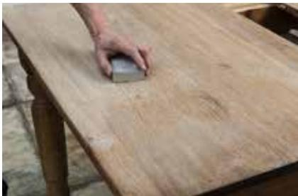
5. Die gesamte Fläche schleifen. Einfacher als von Hand geht das mit einem elektrischem Schleifgerät.
