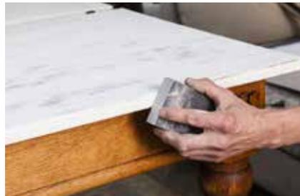
5. Auch die umlaufende Tischkante mit ein Schleifschwamm durchschleifen.
