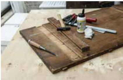
5. Auf der Unterseite hat sich die sogenannte „Gratleiste“ gelöst. Solche Leisten sind unter Tischplatten häufig zu finden. In eine Nut unter der Tischplatte eingeschoben, hält sie diese gerade.
