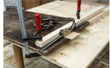
3. Holzleim braucht Druck um gut abzubinden. Die Platte mit langen Schraubzwingen oder mit einem Zurring zusammenziehen. Mit zwei Latten und Schraubzwingen auf einen ebenen Untergrund fixieren.
