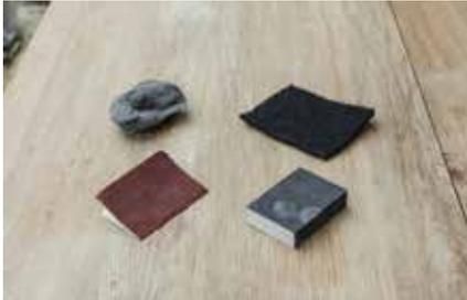
1. Unterschiedliche Schlefmittel: Stahlwolle, Schleifvlies, Schleifpapier und Schleifschwamm.
