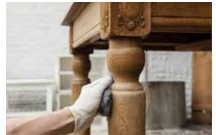
6. Zum Reinigen und Schleifen von Rundungen eignet sich Stahlwolle.
