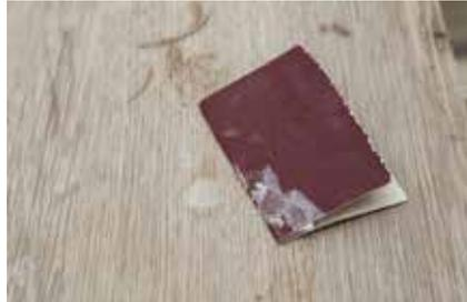
2. Auf der Tischplatte sind Wachsreste. Wie hier zu sehen, verklebt das Wachs das Schleifpapier und wird auf der Fläche verreiben – keine gute Lösung!
