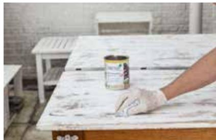
8. Die Tischplatte zweifach mit Hartwachsöl einlassen. Nach Trocknen des ersten Auftrags mit sehr feinem Schleifpapier zwischenschleifen. Die Tischplatte alternativ mit einem Klarlack streichen.
