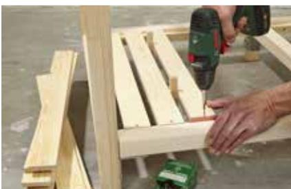
**20.** Die Leisten testweise einlegen, Abstände ermitteln und anschrauben (Schrauben 3,5x30). Auf's Lückenmaß zugeschnittene Abstandshölzer erleichtern die Arbeit.
