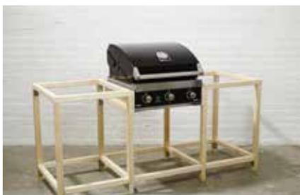
**16.** Dem von uns verwendeten Einbaugrill liegen Winkel bei, die sich seitlich anschrauben lassen (auf Bild Schritt 11. zu sehen). So lässt sich der Grill einfach auflegen und mit wenigen Schrauben fixieren.
