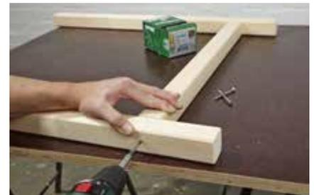
**6.** Die Teile per Verschraubung (4x60) verbinden. Vorbohren nicht vergessen.
