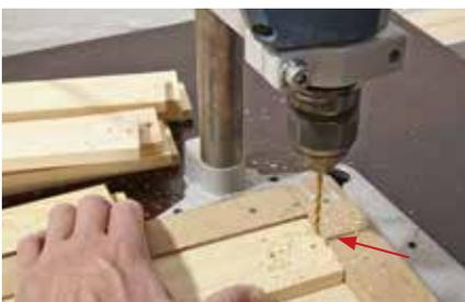
**19.** Um die vielen Leisten vorzubohren, lohnt es sich, eine Unterlage mit Anschlag zu bauen: In den Winkel lassen sich die Leisten einlegen, eine Markierung am Rand zeigt die Position des Bohrlochs.
