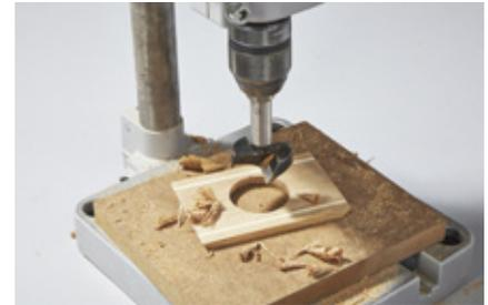
3. Mit einem Forstnerbohrer das Loch im Deckel fertigen.
