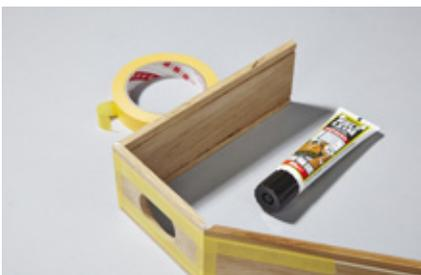
7. Den Turm verleimen: Seiten und Deckel in der richtigen Position und Reihenfolge auf ein Klebeband aneinander legen. Leim an die Gehrungen angeben, die Teile zusammenklappen. Die drei Elemente des Abrollblocks genauso verleimen.
