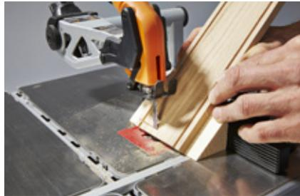
2. Die so hergestellten Teile auf Gehrung schneiden. Das geht per Stichsäge mit Stichsäge Tisch: Ein auf 45 Grad zugesägtes Holzstück am Anschlag unterlegen. Oder mit Kreis- oder Kappsäge arbeiten. Auch die drei Elemente des unten eingeleimten Abrollblocks zuschneiden.
