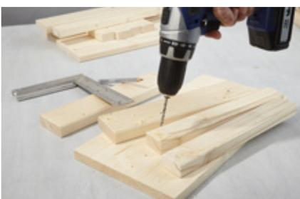
**7. Das unterste** Element mit Leim und Schrauben zusammenbauen. Die Werkstücke, in denen später die Schraubenköpfe sitzen, mit dem 4-mm-Bohrer vorbohren.
