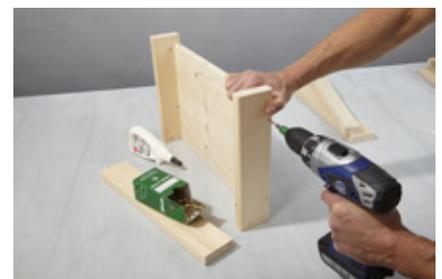
**9. Leisten** durch die vorgebohrten Löcher anschrauben.
