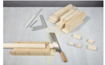
**3. Die Leisten** nach Materialliste zuschneiden. Wer keine Kreis- oder Kappsäge hat, kann mit einer Gehrungslade plus Feinsäge arbeiten.
