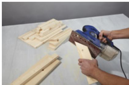
**5. Alle Leisten** rundum schleifen. Ober- und Unterseite der Bodenplatten ebenfalls schleifen.
