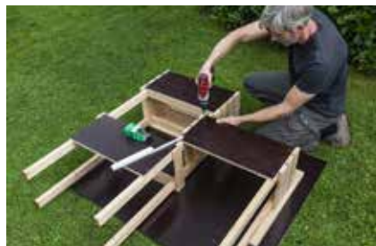
23. Die Rückwand dieses mittleren Moduls jetzt an das erste Regalmodul anschrauben.
