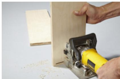
**5.** Mit der Flachdübelfräse die Nuten in Fläche und Kante fräsen. Alternativ mit der Dübellehre die 6er-Dübel anzeichnen und einbohren.
