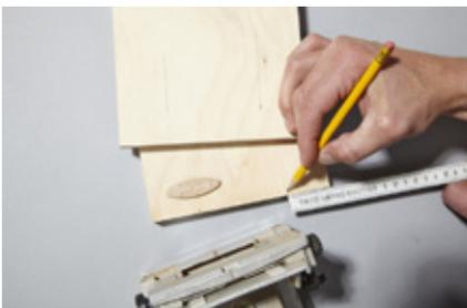
**4.** Die Teile des Korpus zusammenbauen. Die Elemente verleimen – mit Ausnahme der Fachböden, die lediglich eingelegt werden (siehe dazu Zeichnungen auf Seite 6). Die Dübel setzen. Dazu die Position der 10er-Flachdübel anzeichnen.
