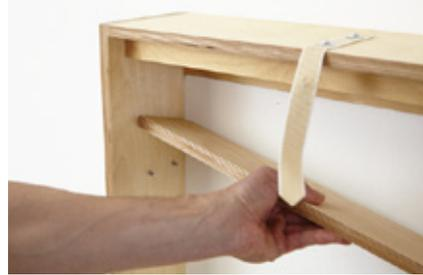
29. Fachbodenträger und Fachböden einsetzen.
