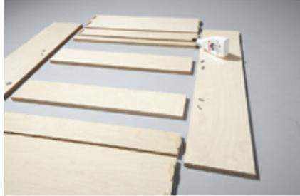
**2.** Die Teile für den Wandkorpus im Überblick: Seiten-, Ober- und Unterteil, 70-mm-Rahmenbretter oben und unten, der Anschlag für den Tisch und die Fachböden.
