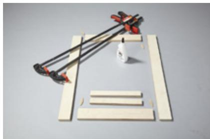
**14.** Die Bestandteile des klappbaren Fußteils im Überblick: Beine, Querstreben und die Teile, aus denen die Ablage für die Tafelkreide gebaut wird.
