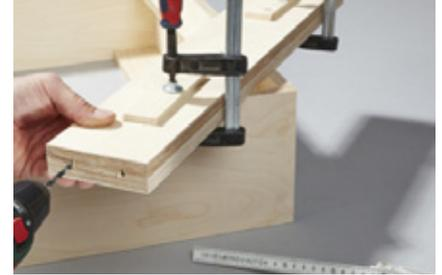
**12.** Die Fachböden müssen fest sitzen, denn sie halten die Rückwand in Position. Deshalb zwei Mulden für die Fachträger schaffen: Die Böden zusammenspannen und an der Kante etwa 10 mm tief einbohren.
