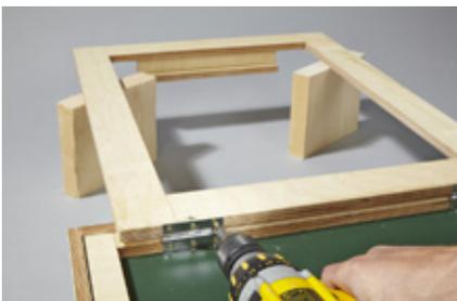
**22.** Beim Anschrauben können Hilfsklötze zum Unterlegen nützlich sein.
