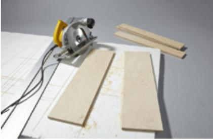
**1.** Die schmalen Teile können Baumärkte auf ihren großen Plattensägen meist nicht auf Maß zuschneiden. Für den Zuschnitt ist eine Tischkreissäge ideal, auch eine Handkreissäge plus Führungsschiene leistet gute Dienste.
