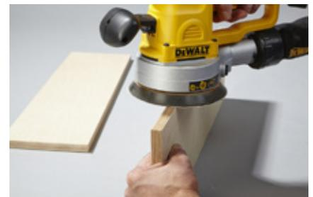
**6.** Vor dem Verleimen alle Teile schleifen. Von den Fachböden auch die Kanten schleifen.
