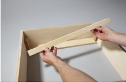
**10.** Der Anschlag für die Tischplatte wird ohne Dübel lediglich verleimt.
