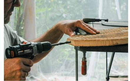
**3.** Hals und Beine anbringen: In das Körperbrett oben ein, unten zwei Löcher bohren. Der Bohrerdurchmesser entspricht dem der Eisen- oder Holzstäbe, hier  $\varnothing$  8 mm.
