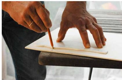
**5.** Die Flügel können aus alten Schrankrückwänden, Bastelholz oder einem Stück Blech gefertigt werden. Die Flügel mit der Schablone (Seite 4) vorzeichnen und aussägen.
