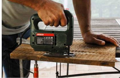
**2.** Aus dem gleichen Material den Kopf aussägen. Die Form mit der Schablone (Seite 3) vorzeichnen und mit der Stichsäge aussägen. Auch hier die Kanten mit Holzfeile und Schleifpapier bearbeiten und brechen.
