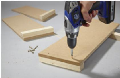
**7.** Die Rahmenhölzer mit den Sitzkorpusrippen verschrauben. Schrauben 4,5x45mm verwenden. Alle Verschraubungen vorbohren!
