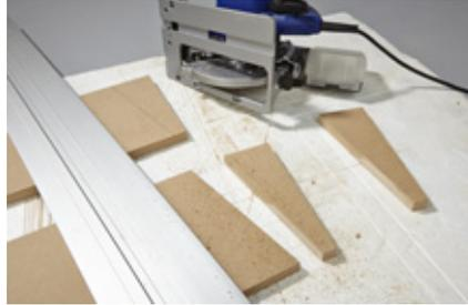
**5.** Entlang der Zeichnung zuschneiden. Auch hier mit der Führungsschiene arbeiten.
