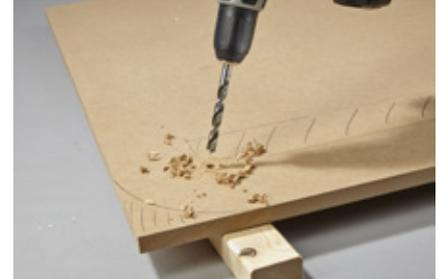
**15.** Beides mit der Stichsäge schneiden. Ins Laptopfach ein Loch fürs Eintauchen der Säge bohren.
