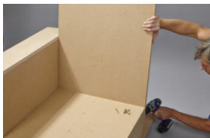
**29.** Die Rückenlehne ebenfalls durch Verschrauben anbringen. Hinten wird mit 4,5x45 mm-Schrauben gearbeitet. Das Regal mit 3,5x50 mm-Schrauben in die Rückwand montieren.
