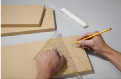
**4.** Unter der Sitzplatte befinden sich drei Sitzkorpusrippen – die beiden Seitenbretter und das Mittelbrett. Alle drei werden hinten ebenfalls im Winkel von 15 Grad angeschragt. Die Schnitte anzeichnen.
