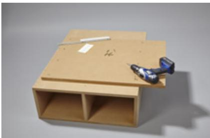
**25.** Die Sockelplatte aus 22-mm-MDF läuft unter Sitzkorpus und Regal. Sie springt auf allen Seiten etwas zurück. Die Platte mit der Sitzkorpus-Unterseite verschrauben (4,5x35 mm-Schrauben).
