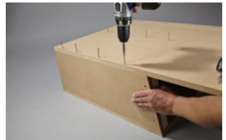
**12.** Die Bodenplatte vorne bündig aufschrauben.
