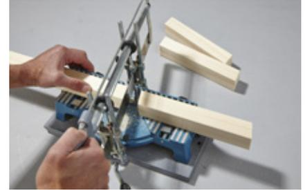
**6.** Für die spätere Montage der Rückenlehne Rahmenhölzer (38x38mm) ebenfalls auf 15 Grad anschrägen. Die Länge an den eben zugeschnittenen Sitzkorpusrippen abmessen.
