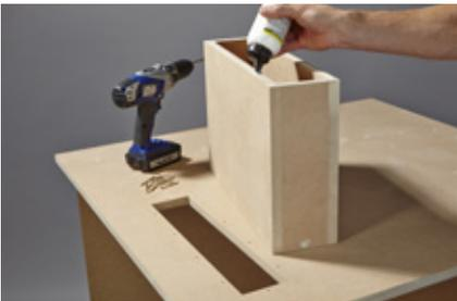
**34.** Das Laptopfach ebenfalls verschrauben, verspachteln und schleifen. Es wird unter Leimangabe mit der Seitenlehne verschraubt (3,5x50 mm-Schrauben).
