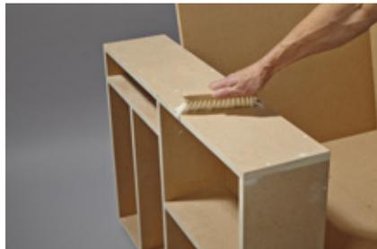
**35.** Nachdem alles montiert und geschliffen ist, den Schleifstaub abbürsten.
