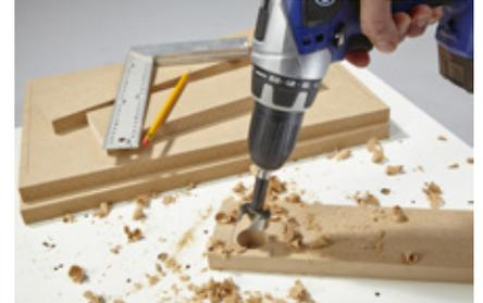
**33.** In eines der Seitenteile mit dem Forstnerbohrer ein Loch für die Stromversorgung schneiden ( $\varnothing$  30 mm).
