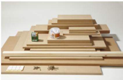
**1. Material:** Zum Bau wurden überwiegend 19 mm starke MDF-Platten verwendet. Lediglich die Sockelplatte ist aus 22 mm starkem MDF.
