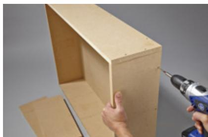
**20.** Die innenliegende Rückwand nach dem gleichen Prinzip einschrauben.
