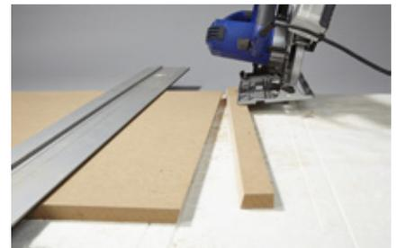
**3. Die Säge um 15 Grad kippen und die Kanten anschrägen.** Dabei unbedingt mit einer Führungsschiene arbeiten. Tipp: Styroporplatte unterlegen.
