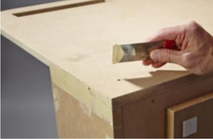
**31.** Auch hier: Alle Schraubenlöcher mit 2-Komponenten-Spachtel verschließen, gründlich schleifen, Kanten brechen.
