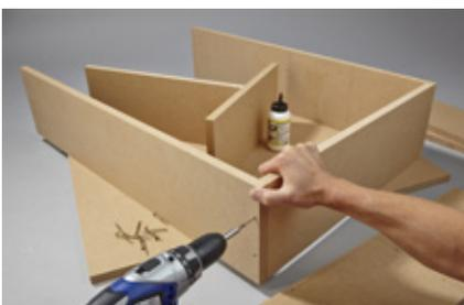
**19.** Deckel und Boden mit den Seiten verschrauben: vorbohren, Leim angeben, zusammenschrauben. Schraubengröße: 3,5x50 mm.
