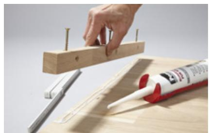
9. Wasserfesten Leim auftragen und zunächst die Leiste befestigen, die später Sitzplatte und Seitenwange verbindet. Im Bild wird die Leiste an die Seitenwange geleimt.
