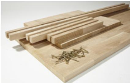
1. Material: Eichenholzplatten mit einer Stärke von 27 mm, Leisten 35x27 mm und Schrauben.
