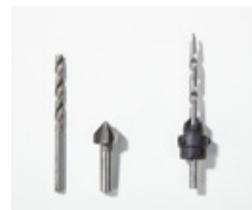
*Vorbohren der Schrauben: Ins harte Eichenholz muss vorgebohrt und die Schraube versenkt werden. Das geht entweder in zwei Arbeitsschritten mit den beiden links abgebildeten Bohrern oder mit einem Bohrer mit Aufstecksenker (rechts).*
