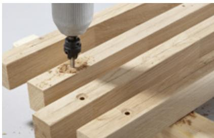
5. Ins harte Eichenholz muss vorgebohrt werden. Wenn 4x50er-Schrauben verwendet werden, sollten die Leisten mit einem 4er- oder 4,5er-Bohrer vorbereitet werden. Bohrlöcher mit dem Senker bearbeiten.
