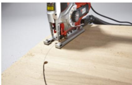
7. Ein großes Loch innerhalb der Kreislinie ermöglicht das Ansetzen der Stichsäge. Kreis aussägen.
