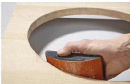
8. Die Innenkante schleifen und die Kanten brechen. Wer keinen Schleifklotz für Radien hat, kann das Schleifpapier auch mehrfach falten und „frei Hand“ schleifen.
