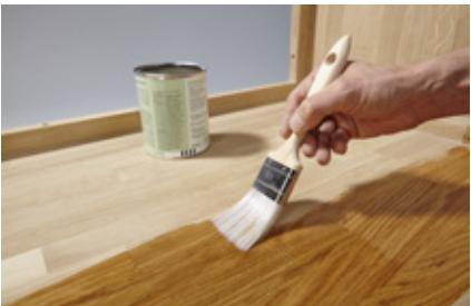
**14.** Das Möbel nach dem Zusammenbau ölen. Öl auftragen, einziehen lassen, mit einem Lappen abnehmen. Von Hand zwischenschleifen (Körnung 320) und nochmals ölen. Das überschüssige Öl nach jedem Auftrag gut abreiben, da es sonst klebt. Lappen ausgebreitet im Freien trocknen lassen – wegen Selbstentzündungsgefahr.
