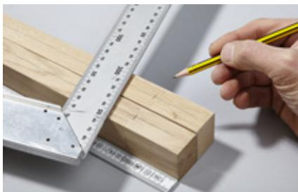
4. Bohrlöcher auf den Leisten anzeichnen. Die Bohrlöcher an der schmalen Seite anzeichnen. Das erste Loch jeweils etwa 5 cm vom Rand. Die Leiste im Winkel von Sitzfläche und Seitenwange erhält von beiden Seiten Löcher (siehe auch Schritt 9).
