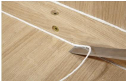
**13.** Den Leim nach dem Trocknen mit einem scharfen Stecheisen abnehmen.
