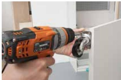
**2.** Die Distanz zum Boden wird durch angeschraubte, 70 mm hohe Lenkrollen mit Anschraubplatte überbrückt.
