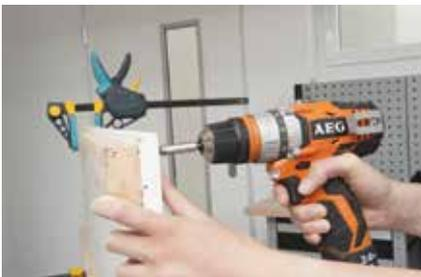
**1.** Leisten mit der Stichsäge auf Maß sägen. An den Türen im Abstand von ca. 10 mm zu den Außenkanten anschrauben – sie dienen auch als Türgriff.
