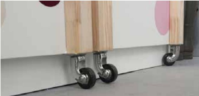
Grundlage ist der 1.000 x 2.010 x 600 mm große Ikea-Kleiderschrank „Pax“. Leisten verstärken die Türen und darunter angebrachte Rollen entlasten die Scharniere. So kann auch an den Innenseiten Werkzeug untergebracht werden. Eine an der Rückwand angebrachte Lochplatte hält das Werkzeug übersichtlich bereit. Auszugskörbe bieten viel Platz für große und kleine Teile. Die Lichtleiste und die Mehrfachsteckdose sind mit Montageband befestigt.
