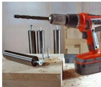
8. **Hängeregal:** Regalbretter übereinander spannen, und die Bohrungen für die Schraubverbindungen setzen.
