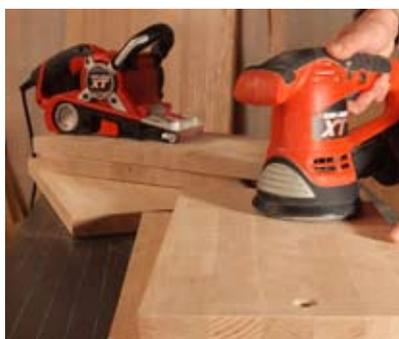
14. Nun alle Holzbauteile schleifen (Körnung 120). Die Flächen mit einem Rotationsschleifer bearbeiten, für die Kanten ist ein Bandschleifer sehr gut geeignet.
