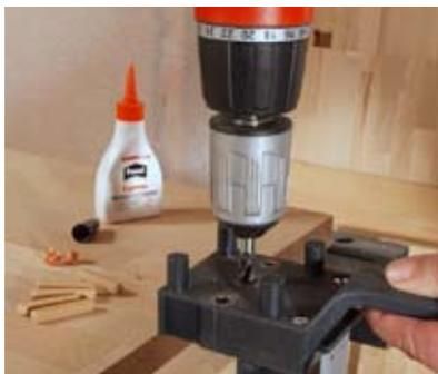
11. **Rollwagen:** Eine Dübel-schablone garantiert eine exakte Verdübelung der Bauteile. Durchmesser der Bohrungen: 8 mm.
