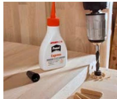
12. Mit einem Markierungs-dorn lässt sich die Bohrung des Gegenstücks genau anreißen. Bohrtiefen-Begrenzer verwenden.
