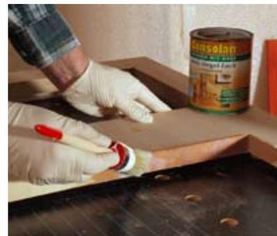
18. Um die Kanten der Ausschnitte in der Deckplatte gut gegen Feuchtigkeit zu schützen, erhalten diese einen doppelten Lackauftrag.
