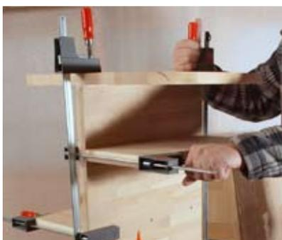
13. Zunächst wird der Wagen verleimt und bis zum Abbinden des Leims mit Zwingen fixiert.
