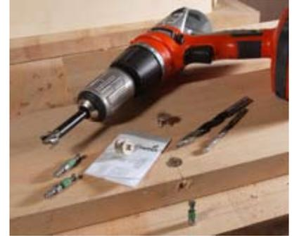
3. Loch für den Verbindungsstift bohren (Ø 5 mm), Stift einschrauben. Der Packung liegt eine Bohrschablone mit Maßangaben bei.
