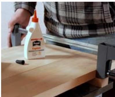
10. Die Verleimung mit Zwingen fixieren. Expressleim bindet bei Raumtemperatur in einer Stunde ab.
