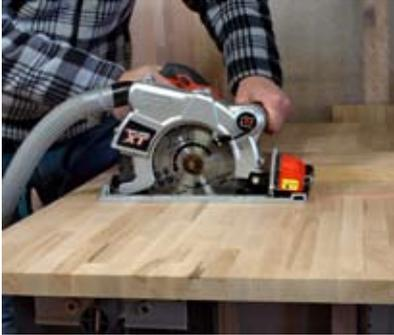
1. Zuschnitt im Baumarkt oder per Handkreissäge. Mit Anschlag und Lasermarkierung werden die Schnitte präzise.
