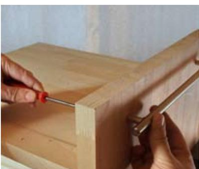
16. Griffe am Rollwagen montieren: Die Frontblenden mit 5-mm-Bohrungen versehen und die Griffe von hinten anschrauben.
