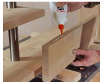
9. Die Mikrowelle braucht eine größeren Regaltiefe. Mit einem Plattenabschnitt wird daher eines der Bretter verbreitert.
