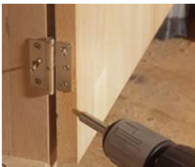
7. Die Tür, hinter der der Kühlschrank verschwindet, mit Scharnieren festschrauben.
