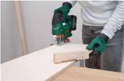
1. Die Skizze (rechts) auf die breiteste Multiplexplatte (12 x 262 x 1800 mm) übertragen. Anschließend mit der Stichsäge entlang der Markierungen das erste Garderobenteil aussägen. Die Platte mit Zwingen fixieren.
