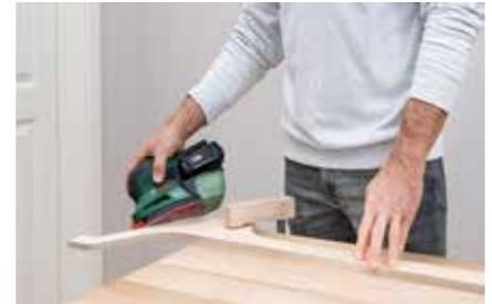
**4.** Die einzelnen Garderobenteile und Rechteckleisten schleifen (120er-Körnung). Die Kanten ggf. erst nach dem Streichen schleifen. Anschließend alle Holzstücke in der Wunschfarbe lackieren. Beim Trocknen des Lacks die Herstellerhinweise beachten.
