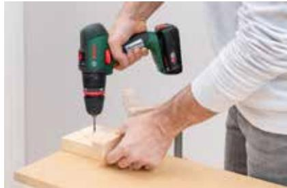
**3.** Die Leisten zusammenspannen und dann an je vier Stellen vorbohren. Wichtig dabei: Die Bohrungen versetzt platzieren, damit sich die Schrauben später nicht in die Quere kommen. Beispielsweise so: Auf einer der Seiten mit einem Abstand von 20 mm zur oberen Kante und 30 mm zur unteren Kante. Auf der daneben liegenden Seite umgekehrt: Zwei Bohrlöcher, 30 mm zur oberen Kante und 20 mm zur unteren Kante (siehe Skizze unten). Bohrlöcher ggf. mit einem Senkbohrer nachbohren.
