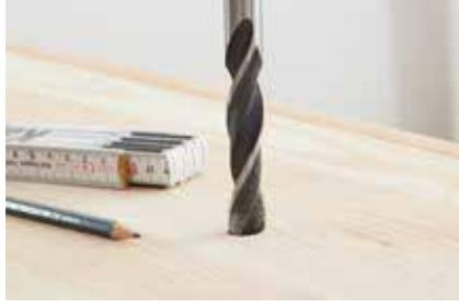
**2.** Anschließend können die einzelnen Bretter miteinander verschraubt werden. Auf der Unterseite des zusammengesetzten Kastens werden nun Bohrlöcher für den Wasserdurchlass eingezeichnet und dann eingebohrt. Jeweils ca. 20 cm von der Außenkante entfernt.
