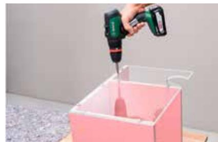
**6.** Die Seitenteile mit Fingerspitzengefühl aufschrauben. Schrauben eindrehen, nicht anziehen.
