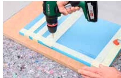
**3.** Jetzt die Acrylglasscheiben bearbeiten. Beide Scheiben mit Klebeband aufeinander fixieren, dabei die Bohrstellen mit abkleben. Die Löcher auf Höhe der Regalböden setzen (siehe Skizze S. 3, zum Anzeichnen der Bohrlöcher die Platten seitlich auflegen). Zusätzlich drei Löcher für die Verbindung mit der Rückwand bohren. Tipps zum Bearbeiten von Acrylglas auf S. 1 beachten!
