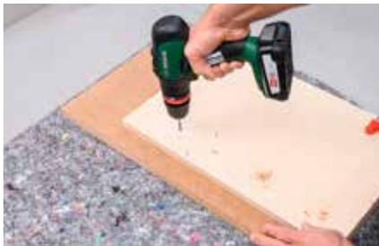
**1.** Die größere Multiplexplatte (Rückwand, 450 x 300 mm) vorbohren: Die Löcher für die Befestigung der Böden und der Wandbefestigung einbohren (siehe Skizze S. 3).
