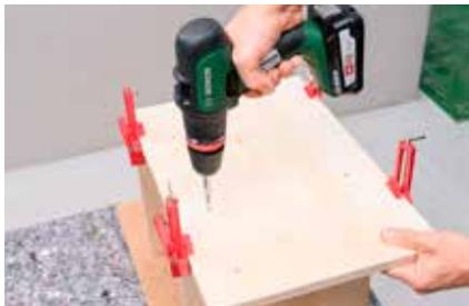
**2.** Alle Teile schleifen. Die Rückwand und die Böden fixieren. Auf rechten Winkel achten! In die Regalböden vorbohren, damit sie nicht aufreißen.
