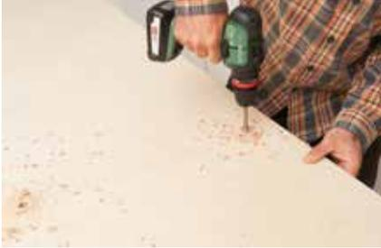
**1.** Auf jedem der Flügel die Kontur für die Bodenschlitze aufzeichnen (siehe Skizze, Schlitzbreite 12 mm). Die Enden mit dem 12er-Forstnerbohrer für den Ansatz der Stichsäge durchbohren. So entsteht auch gleich eine saubere Rundung an jedem Schlitzende.
