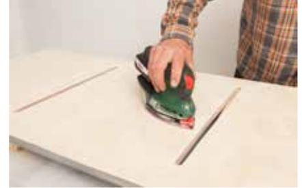
**3.** Die Flächen der Multiplexplatten vor dem Lasurauftrag schleifen und dabei alle Kanten brechen.
