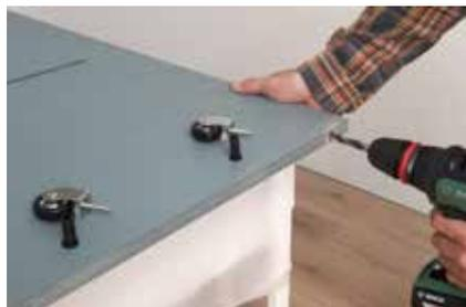
**8.** Die Löcher für die Einsteckhülsen der Teewagenrollen mittig in die Platten bohren. Abstand zu den Rändern rund 50 mm. Darauf achten, dass die Bohrung gerade wird.
