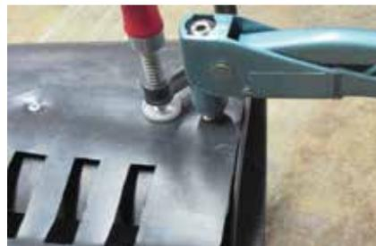
Das Visier wird mit Blindnieten am Helm befestigt. Dazu das Visier mit zwei kleinen Schraubzwingen an den Helm klemmen, die Löcher bohren, die Nieten in die Löcher stecken und mit der Blindnietzange festziehen.
