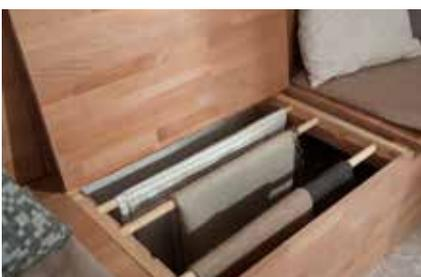
**16.** Tipp für den Zuschnitt der Haltestangen für die Rundhölzer: Einen Leimholzstreifen in Breite von etwa 50 mm zuschneiden. Mit einem Forstnerbohrer in Stärke des Rundholzes mittig die Leiste durchbohren und erst dann die Leiste halbieren. Befestigt wird die Halterung entweder mit Montageband oder mit Schrauben.
