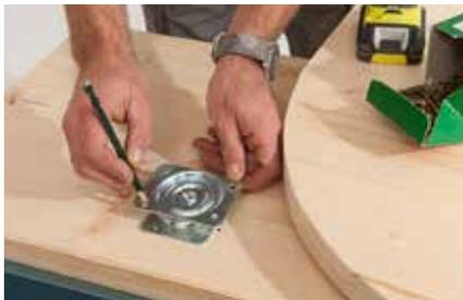
**10.** Den Drehbeschlag an der Tischplatte befestigen. Da man mit dem Schraubendreher nicht zwischen die Platten kommt, muss von unten durch die Abdeckplatte geschraubt werden. Die Bohrlöcher markieren: Die obere Platte des Drehbeschlags um 90 Grad drehen und die Löcher markieren.
