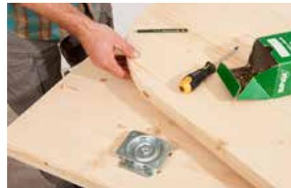
**12.** Jetzt die Tischplatte bündig mit der hinteren Kante über den Drehbeschlag schieben.
