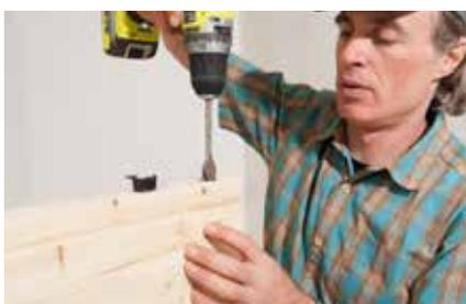
**7.** Für die Beweglichkeit der Tischplatte sorgen Bohrskrollen. Sie werden in die Wangenunterkante eingelassen. Dafür mit einem Spaten- oder Forstnerbohrer zwei Löcher im Abstand von jeweils ca. 50 mm zu den Seitenkanten bohren.
