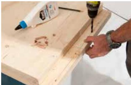
**1.** Tischplatte und Wange mit mindestens vier Dübeln verbinden. Die Position der Dübellöcher auf der Tischplattenunterseite markieren und die Dübellöcher bohren.
