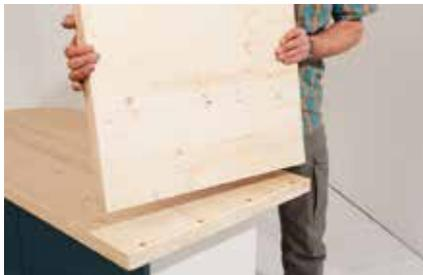
**2.** Gegenbohrung der Dübel: „Dübelifix“ (hier von Wolfcraft) hilft dabei, die Position der Dübel auf der Kante der Wange zu markieren. Beim Ansetzen darauf achten, dass die Platte vorne, hinten und seitlich bündig steht.
