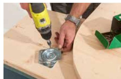
**9.** Das „Besta“-Element erhält eine Abdeckplatte, um die erforderliche Tischhöhe zu erreichen. Auf der Platte wird der Drehbeschlag befestigt, und zwar mit 300 mm Abstand zur Hinter- und zur Seitenkante (s. Skizze S. 2).
