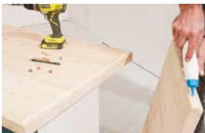
**4.** Holzleim in die Löcher und auf beiden Flächen auftragen, die Dübel in die Wange einsetzen.
