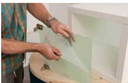
**16.** Für die Türen werden kleinere Acrylglasplatten verwendet. Die Schutzfolie abziehen und den Glastürbeschlag aufstecken.
