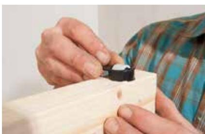
**8.** Bohrskrolle einsetzen. Dann alle Teile schleifen und nach Wunsch oberflächenbehandeln (ölen, wachsen oder lackieren).
