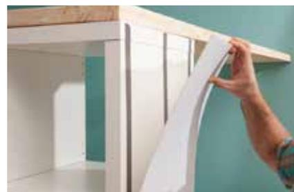
**27.** Als Pinnwand die mit dem Cutter zugeschnittene „Guttaliss Hobbycolor“-Hartschaumplatte mit Montageband ankleben. Für die Optik haben wir zusätzlich hellblaue Filzstreifen über die Breite geklebt.
