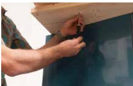
**13.** Die Schrauben durch die Bohrlöcher stecken und die obere Platte des Drehbeschlags von unten an die Tischplatte schrauben.
