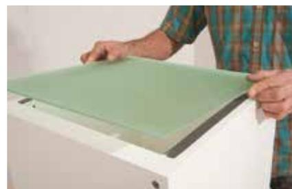
**15.** Mit dem Montageband werden auch die Acrylglas-Rückwände befestigt.
