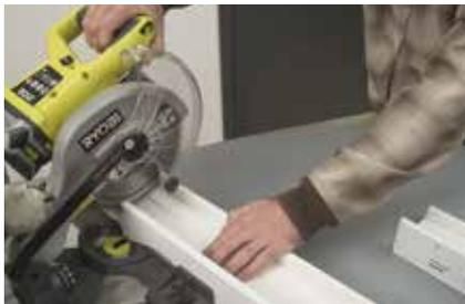
**1.** Die Bilderleisten auf 470 mm kürzen: Dazu eine Stichsäge oder besser eine Kapp- und Gehrungssäge verwenden (damit werden die Schnitte gerader).
