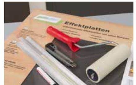
**15.** Für den Zuschnitt der Effektplatten wird ein Cutter benötigt. Für das Andrücken und Glätten einen Gummiroller benutzen.
