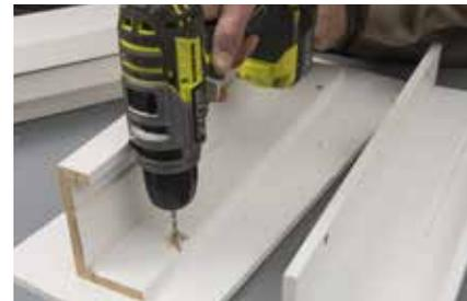
**3.** Das Loch vorbohren (2-mm-Bohrer) und dann mit einem 4- oder 5-mm-Bohrer vergrößern. Damit die Schrauben nicht überstehen, zudem mit einem Versenker arbeiten.
