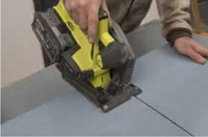
**10.** Schneiden von Acrylglas: ungeschränktes Sägeblatt mit hoher Zahnzahl verwenden, die laufende Säge am Werkstück ansetzen, höchste Drehzahl einstellen und zügig sägen.
