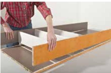
**28.** Nach der Trocknungszeit werden die Rückwände der Kubustüren angebracht.
