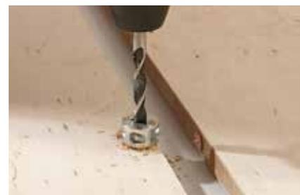
**9.** Dübellöcher anhand der Markierungen mit Tiefenstopp bohren und Dübel einseitig einleimen. Diese Verbindungen ebenfalls mit Verbindungsbeschlägen verstärken.
