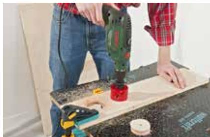
**20.** Damit Gläser und Becher nicht verrutschen, erhalten die Borde zusätzlich Löcher (Lochsäge), in die diese Teile gehängt werden.
