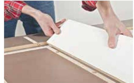
**24.** Mit Hilfe der Lochmarker die Gegenbohrungen auf den Kanten der Einlegeböden markieren. Die Bohrungen in die Seitenwände nicht vergessen.
