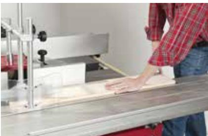
**19.** Die oberen Vorderkanten der zugeschnittenen Einlegeböden und bei den Klapp-tischen auch die Seiten werden mit der Fräse – alternativ mit Schleifpapier – abgerundet.
