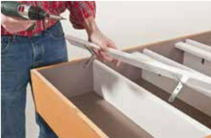
**32.** Die Stopperleisten über den Böden in den Kubustüren werden mit Stuhlwinkeln angebracht.
