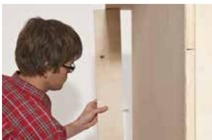
**11.** Blenden auf beiden Seiten auf der Rückseite mit wasserfestem Leim und Dübeln befestigen. Zusätzlich durch das Dach mit einer Schraube fixieren.
