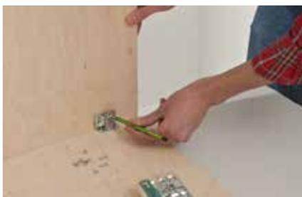
**7.** Zur Verstärkung der Verbindungen werden 5 cm vom Rand Verbindungsbeschläge mit Spannschrauben angebracht. Nach dem Anzeichnen wird der Beschlag angeschraubt und mit dem Inbusschlüssel angezogen.
