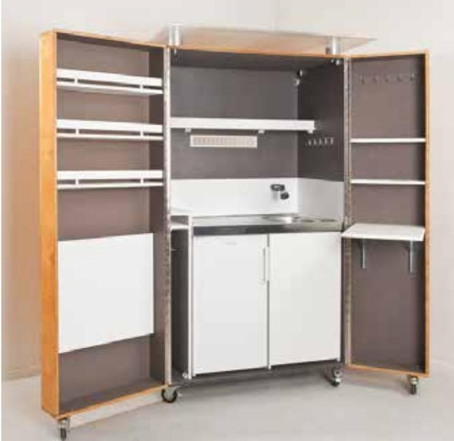
40. Jetzt ist die Kochnische im Schrank fast fertig. Zuletzt wird noch der Ausschnitt für das Lüftungsgitter mit der Stichsäge gesägt. Gitter mit „Kleben, Montieren, Dichten“ einsetzen. An der Rückseite die Haken für Tisch und Stühle anbringen.
