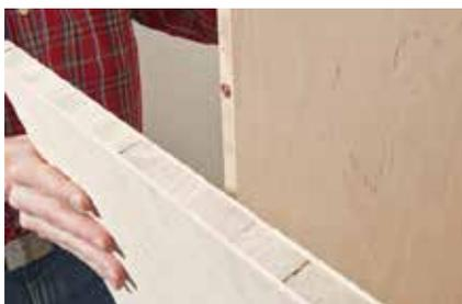
**8.** Die Bohrungen für die Dübellöcher an der Deckel- und Bodenseite der Seitenwand werden mit „Dübelfix“ markiert. Dafür die Platten an der entsprechenden Seite, nach vorne bündig, zusammendrücken, damit die Spitzen Markierungen hinterlassen.
