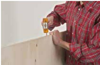
**5.** ... mit einem Gummihammer einschlagen. Die Dübel werden nur einseitig verleimt. So kann der Korpus jederzeit wieder demontiert werden.
