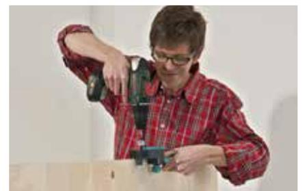
3. Der Akku-Bohrschrauber wird mit einem Tiefenanschlag versehen, damit die Dübel die gleiche Einlasstiefe erhalten. Mit Hilfe des „Meisterdüblers“ Löcher bohren (Ø 8 mm).
