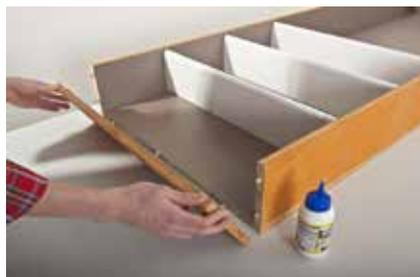
**29.** Zum Schluss den Deckel und Boden einsetzen und während der Abbindezeit des Leims fixieren.
