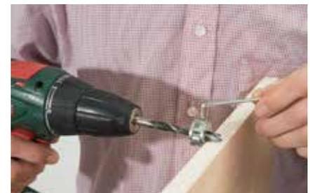
6. Mit dem Bohrer mit Tiefenanschlag die Gegenbohrung vornehmen.
