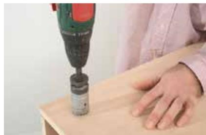
**14.** Mit einer Lochsäge (35er) die Grifflöcher in den Frontplatten ausschneiden, Abstand zur Ober- und Seitenkante je 75 mm.
