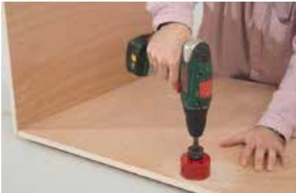
**15.** Winkel aus Rückwand und einer Seite mit Dübeln, Leim und Schrauben anfertigen. Mit einer Lochsäge (68er) ein Loch für die Kabeldurchführung in die Rückwand sägen.
