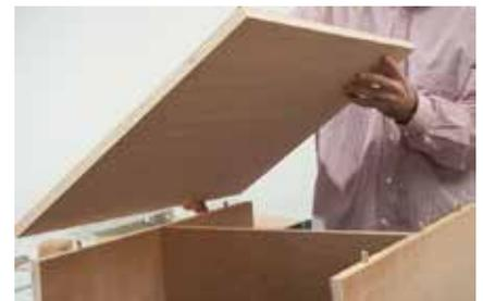
**12.** Die Rückwand unter Zugabe von Leim aufstecken und für die Abbindezeit des Leims mit Zwingen fixieren.
