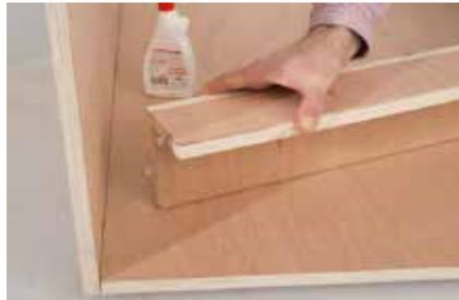
**16.** Den Kanal für die versteckte Mehrfachsteckdosenleiste einleimen. Winkel bündig mit den Oberkanten in das Seitenteil dübeln/leimen und dann die Gegenseite anbringen.
