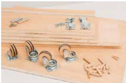
1. Der Korpus besteht aus 18 mm Multiplexplatten – im Baumarkt oder mit der Kreissäge auf Maß geschitten.
