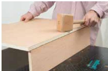
5. Dorne mit dem Holz- oder Gummihammer andrücken. Die Platten sind oben bündig, unten hat die Rückwand einen Überstand.
