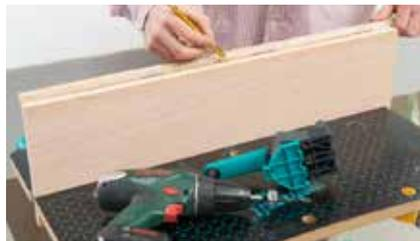
2. Alle Teile werden mit Dübeln verbunden. Hier werden die Dübellöcher der Klappteile angezeichnet: 1 x mittig und jeweils 1 x 100 mm vom Rand.
