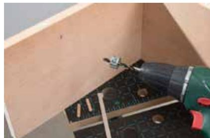
**11.** Bohrung für die obere und untere Stopperstange im linken Klappteil vornehmen (6 mm, ca. 30 mm zur Vorderkante, Abstand zu den Böden ca. 120 mm). 6-mm-Dübel einleimen, Stange aufstecken. Auf der Gegenseite ebenso verfahren. Gegenseite aufleimen, mit Zwingen fixieren.
