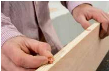
4. „Dübelifix“ einsetzen. Damit werden die Gegenbohrungen markiert.
