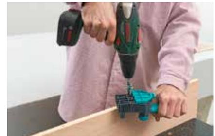
3. Beim Dübeln ist eine Dübellöhre hilfreich. Mit einem 8-mm-Bohrer die Löcher an den markierten Stellen bohren.
