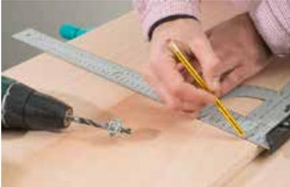
**7.** Die beiden Seitenwände bündig zusammenlegen und eine durchgehende Linie für die Position der Zwischenböden ziehen.
