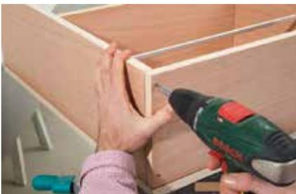
**13.** Den unteren Boden an die Unterkanten der Seiten leimen und mit Schrauben fixieren.
