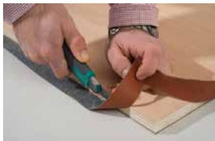
**22.** Die Überstände mit einem Cutter bündig abschneiden. Eventuell einen Zierstreifen als Umleimer auf die Seitenkanten zur Abdeckung der Lederkante leimen (ca. 2 mm stark, aus Multiplex zugeschnitten).
