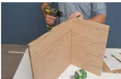
**4.** Rückwand und Deckel oder Boden im rechten Winkel zueinander aufstellen und verschrauben.
