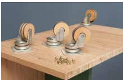
**7.** Die vier Rollen werden im Abstand von zirka 30 mm zu den Außenkanten angebracht. Zwei der Rollen sind mit Feststeller ausgestattet, damit der Beistelltisch fixiert werden kann.
