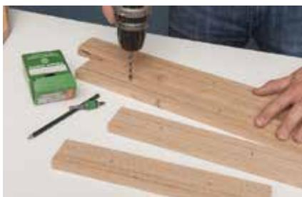
**8.** Die Schraublöcher im Tabletrand vorbohren. Der Rand überragt den Boden oben und unten, daher die Schraublöcher mittig platzieren. Plattenstärke anzeichnen und vorbohren.
