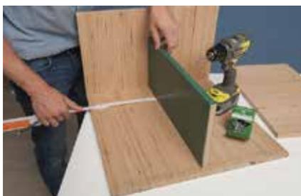
**5.** Position der Mittelwand ermitteln, diese auf den Außenseiten von Boden und Deckel markieren und jeweils zwei Schraublöcher vorbohren.
