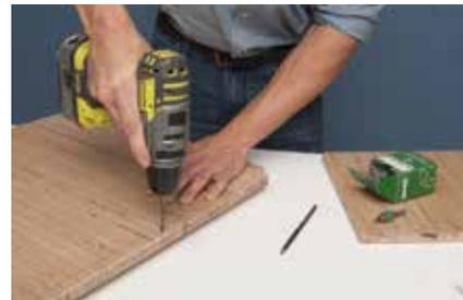
**3.** An Boden und Deckel je vier Schraublöcher anzeichnen und vorbohren.
