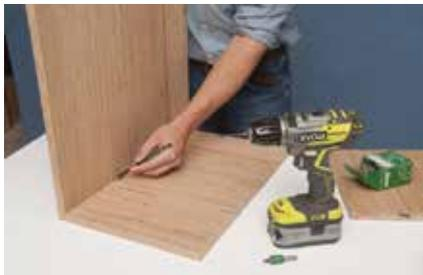
**2.** Der Korpus wird einfach zusammengeschaubt. Fürs Vorbohren die Rückwandplatte senkrecht auf Boden und Deckel aufstellen und die Plattenstärke anzeichnen.
