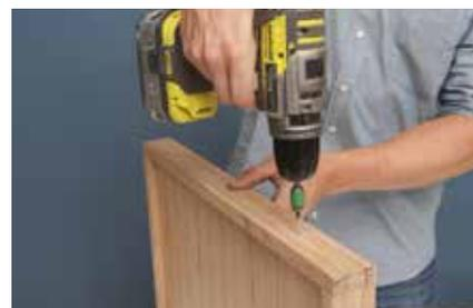
**9.** Tabletrand anschrauben. Dann nur noch das Gummiband für die Schlaufenhalterung mit den Holzklötzen, die Stopperleiste und den Griff als Buchhalterung anschrauben.
