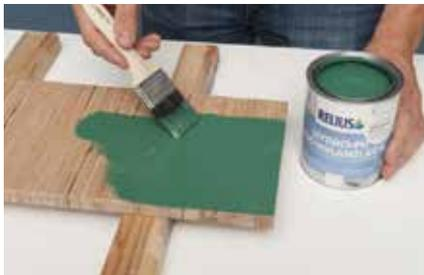
**1.** Die Mittelwand und die Kleinteile farbig streichen, alle anderen Holzteile mit Klarlack überziehen. Alle Elemente vorher schleifen (Körnung 120), nach Trocknen des ersten Farbauftrags zwischenschleifen (Körnung 280).
