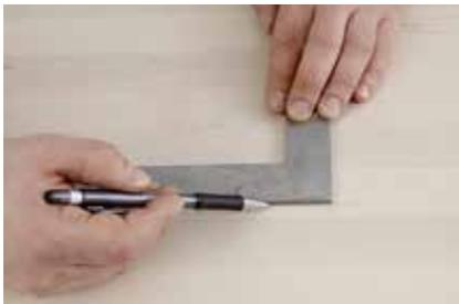
**2.** In der Mitte des Tisches zunächst mit dem Winkellineal die Aussparung für den Grill anzeichnen. Sie sollte auf allen Seiten mindestens einen Zentimeter größer sein als der Grill.
