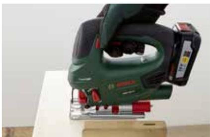
**4.** Die Wandteile für den Unterbaukasten herausschneiden: entsprechend der Maße des Grills zwei kürzere und zwei längere Teile.
