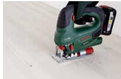
**3.** An allen Ecken des Ausschnittes innerhalb der Markierung ein Loch vorbohren. Verwenden Sie hierfür den 18-mm-Holzbohrer. Die Löcher als Ansatz für die Stichsäge benutzen.
