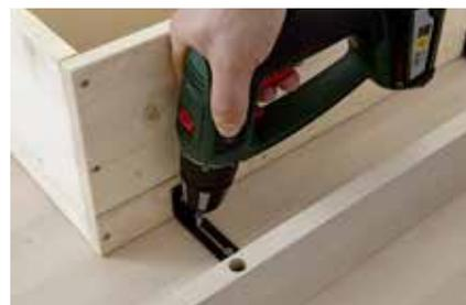
**6.** Den fertigen Kasten mit den beim Grill mitgelieferten Metallwinkeln direkt unter der ausgesägten Aussparung am Tisch montieren.
