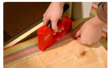
**9.** Auf die Oberseite Rollkästendeckel Schaumstoff und darüber den Bezugsstoff legen. Die Überstände umschlagen und auf der Unterseite antackern.
