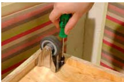
**8.** In jede Ecke der Bodenplatte wird eine Bockrolle montiert.
