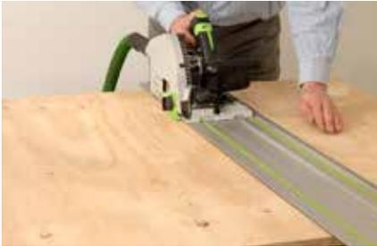
**1.** Die Platten im Baumarkt zuschneiden lassen oder selbst mit Handkreissäge und Führungsschiene zusägen.
