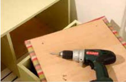
**10.** Als Rutschstopper und Abdeckung der Bezugsstoff-Enden wird auf die Unterseite der Deckel eine weitere Platte geschraubt.
