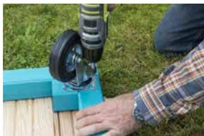
**14.** Damit die Räder an vier Punkten angeschraubt werden können, wird in jeder Ecke ein zirka 50 mm langer Konstruktionsvollholzabschnitt angebracht.
