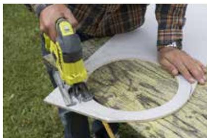
**13.** Der Zuschnitt des Blendrahmens erfolgt ebenfalls mit der Stichsäge. Auch das Acrylglas mit einem für harte Kunststoffe geeigneten Stichsägeblatt zuschneiden.
