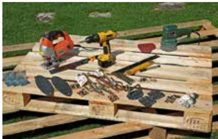
1. Für den Bau Ihres Palettensessels benötigen Sie Stich- und Lochsäge, einen Akkuschrauber sowie Zollstock, Bleistift, Zange und Winkel.
