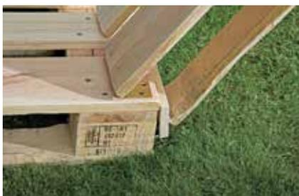
**13.** Angeklappt in mittlerer Position stützt sich die Lehne auf die Leiste. Weggeklappt steht sie in Liegeposition.
