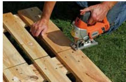
3. Sägen Sie eine der Paletten kurz hinter dem Mittelklotz durch. Der längere Teil wird zur Sitzfläche, der kürzere zur Lehne.
