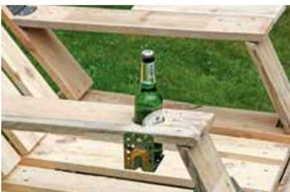
**25.** In die andere Armlehne mit der Lochsäge ein Loch von 65–70 mm Durchmesser schneiden und seitlich den Schwerlastwinkelverbinder montieren. Jetzt verfügt Ihr Sessel über einen Flaschenhalter.
