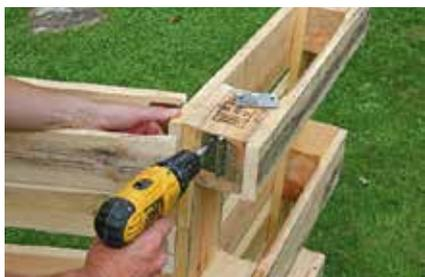
**10.** Schrauben Sie dann zwei kleinere, halbbreite Scharniere an der Rückseite fest.
