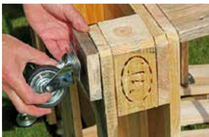
**14.** An allen vier äußeren Ecken ein Brett unterlegen und je eine Lenkrolle befestigen.
