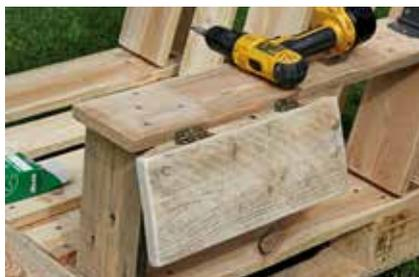
**23.** Aus der zweiten Palette eine Platte für den Klappptisch zusägen und mit zwei Scharnieren an einer der Armlehnen montieren.
