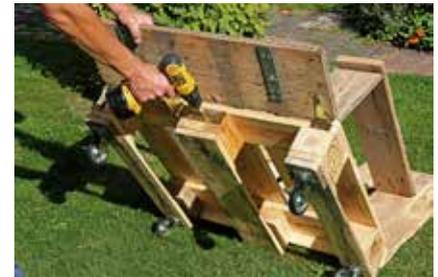
**21.** Für die Fußstütze zwei Leisten mit Flachverbindern zusammenfügen. Mit zwei Kistenbändern am Sitz befestigen. Das mittlere Kistenband dient zum Verstellen der Fußstütze.
