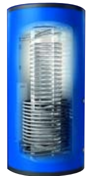
Kombispeicher: Das frische Trinkwasser durchfließt in einem Wellrohr den großen Heizungswasserspeicher. So findet eine hygienisch einwandfreie, bedarfsgerechte Erwärmung statt. (Schüco)
