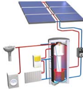
Der Solarspeicher steht als Schnittstelle zwischen Wärmeerzeugung und Wärmeverteilung im Mittelpunkt des Heizsystems. (Wagner & Co.)
