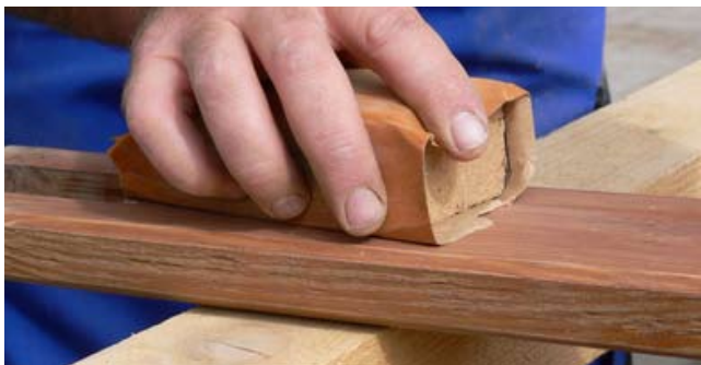
Ein Schleifklotz verhindert, dass die Oberfläche beim Schleifen wellig wird.
