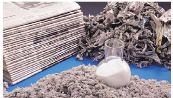
Zellulose-Flocken werden aus Altpapier hergestellt.
